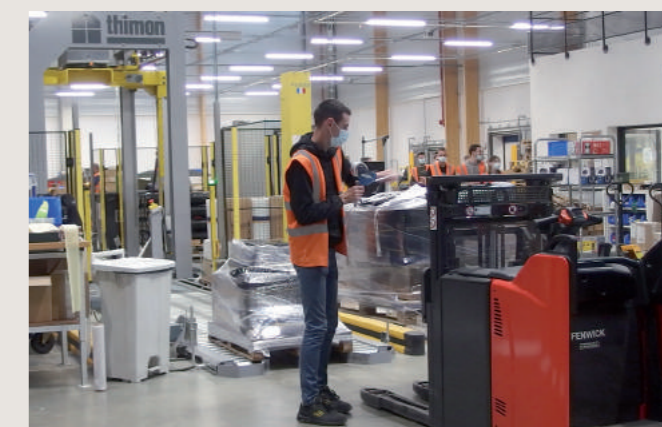
Le collecteur dépose la palette en zone d'attente et ensuite l'emballer prend la relève, ce qui permet un double contrôle de la commande et a permis de diviser par deux les litiges. La filmeuse automatique est en mesure de filmer 40 palettes par heure. Le film transparent est recyclé. Au total, la préparation gère 250 commandes par jour, de la simple enveloppe avec une buse au container complet.
