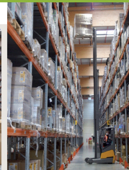
Le troisième mode de stockage repose sur des racks classiques de 13 mètres de haut (10 mètres utiles). Le cariste se charge des palettes situées en hauteur et les laisse à hauteur d'homme pour le collecteur.
