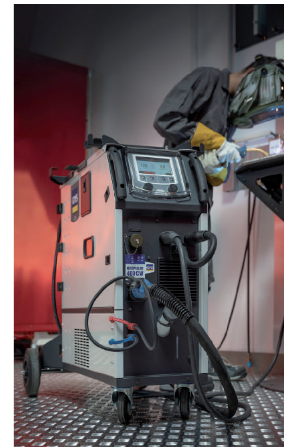
Le générateur MIG/MAG 400 A pulsé Neopulse 400 CW est le dernier de la gamme. Il représente une solution tout en un avec le groupe froid et le dévidoir intégré. Il dispose en natif de la traçabilité de tous les cordons de soudage.
